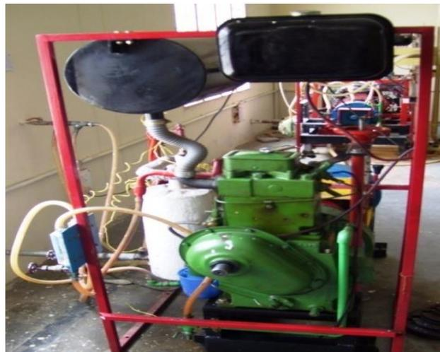
**Figure 1.** Diesel Engine Test Rig.
